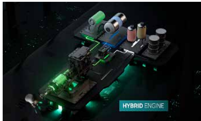
Machinekamerconfiguraties: De traditionele verbrandingsmotor, de elektrische voortstuwing en de hybride machinekamer met verbranding en/of brandstofcel (H 2 , methanol, ammoniak).
