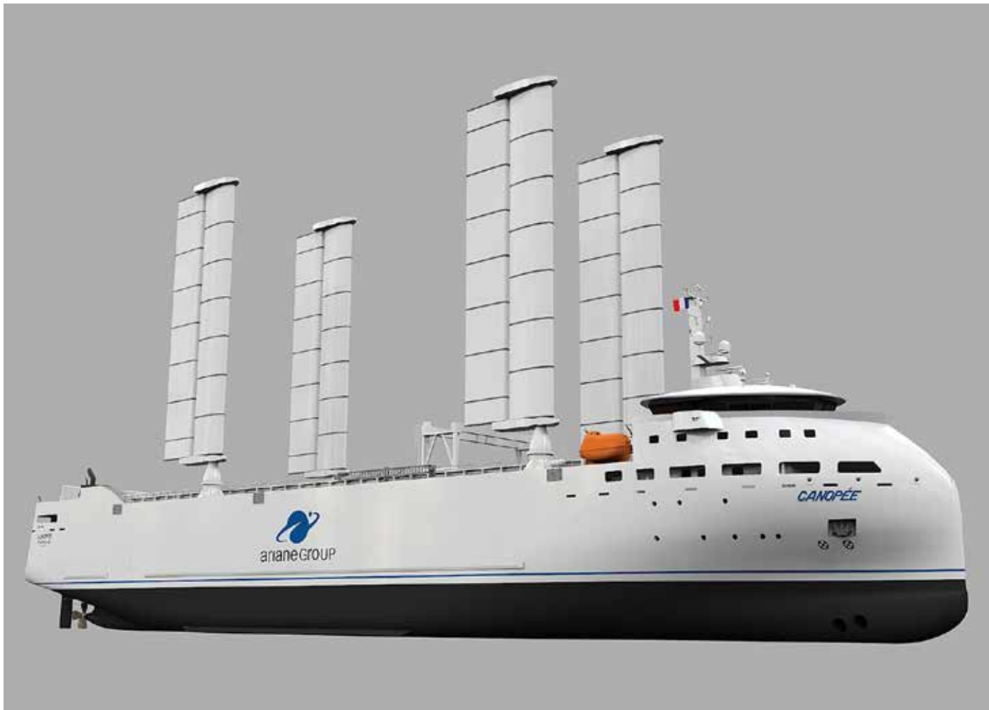
Wind(hulp)voortstuwing is klaar voor een comeback. Zo bouwt Neptune Shipyards de Canopée. Het 121 meter lange schip zal worden uitgerust met vier 30 meter hoge Oceanwings (foto Neptune Shipyards).
