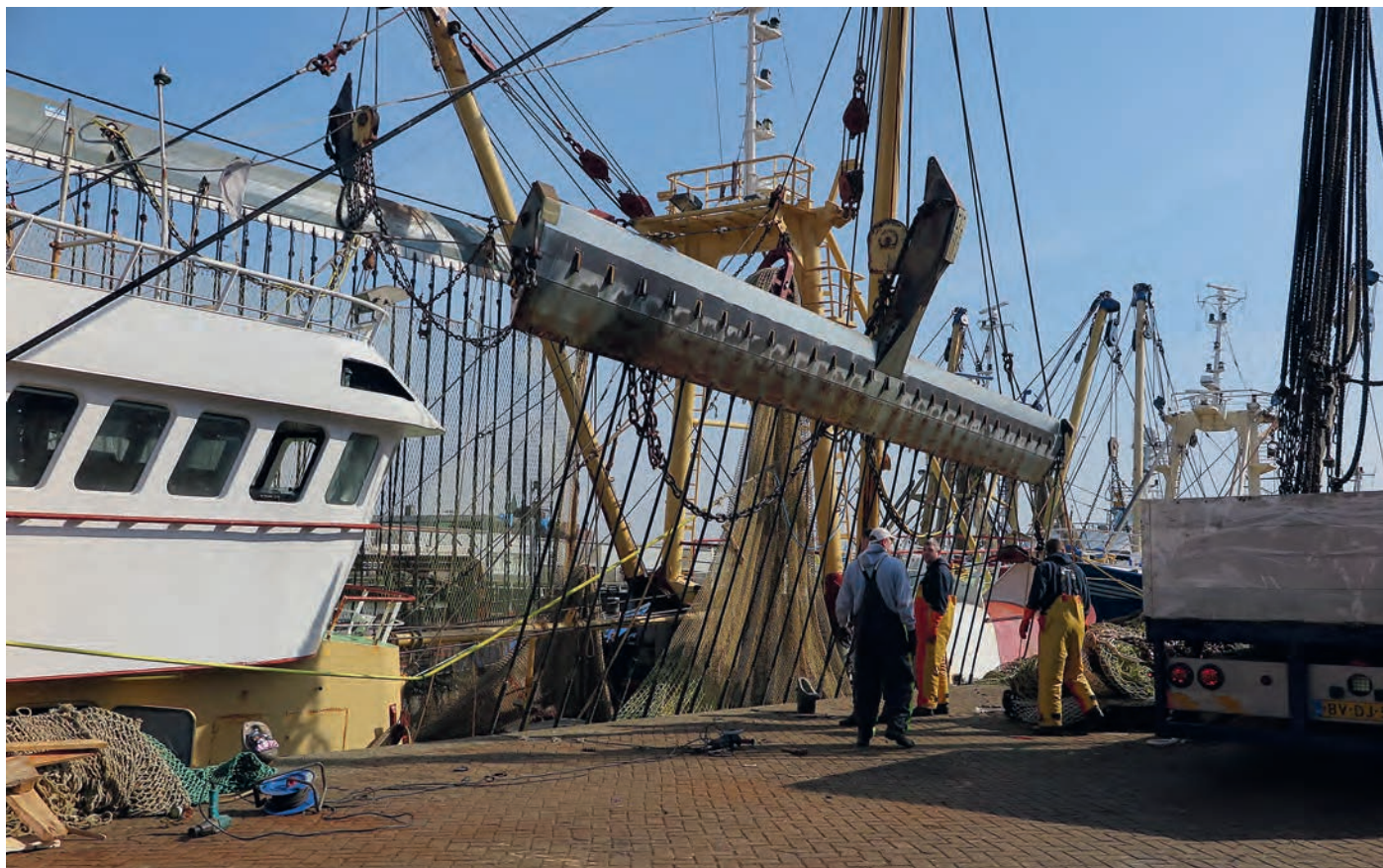
Het puls swingtuig van de koster UK 197 Noorderlicht (geb. 1993, 1992 pk) in 2017. Duidelijk zichtbaar zijn de zwarte stroomkabels die met kleine stroomstootjes de platvis opschrikken zodat ze in het net terechtkomen. Het geheel hangt aan een sumwing, een stalen constructie met een vleugelprofiel die, anders dan de klassieke boomkor, boven de zeebodem zweeft en bodemberoering tot een minimum beperkt. Sinds het pulsverbod vist de UK 197 weer met de boomkor waarbij kettingen de zeebodem omploegen en zo de platvis uit de grond jagen.
