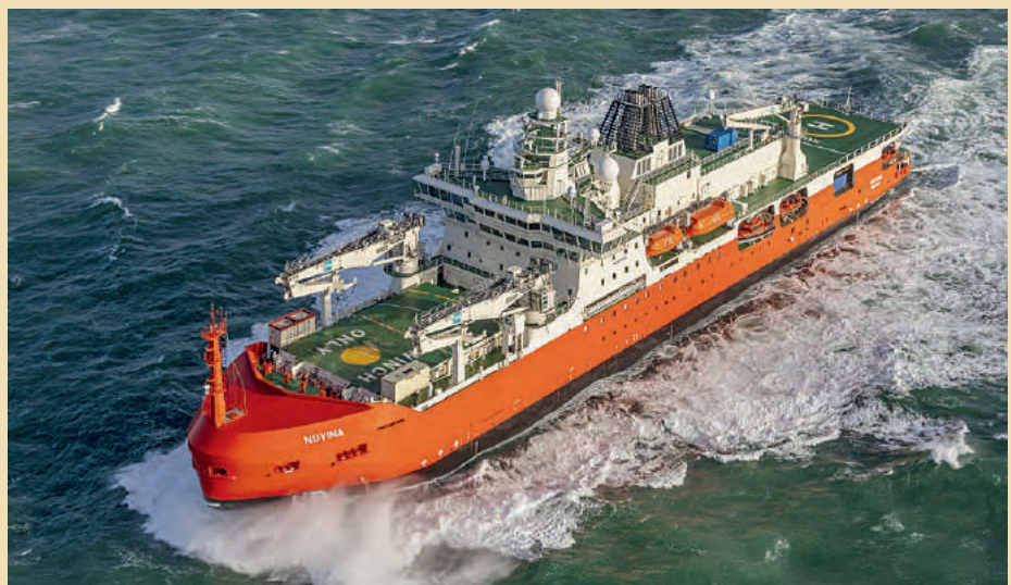
De Nuyina is in staat om door 1.65 meter dik ijs te breken met een snelheid van 3 knopen.
