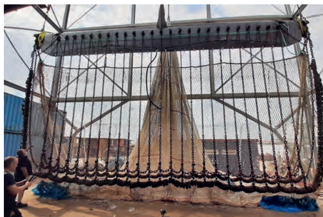
HFK (de uitvinder van de Sumwing) heeft een nieuwe wing getekend (afgeleide van een vliegtuigvleugel) en de nettenafdeling van Jaczon/Cornelis Vrolijk ontwierp nieuwe netten.
