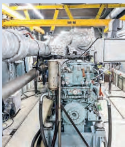
De zes-cilinder S6R-MPTK/MPTAW-motor maakte ruim 2500 draaiuren op de testbank van het Powertrain Test Centre van TNO in Helmond.
