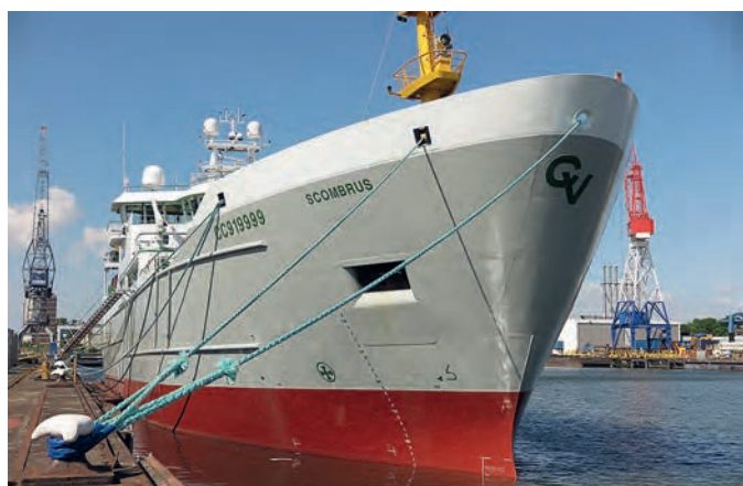
De jongste vriestrawlers die voor Noord-Europese rekening gebouwd worden, zijn aanzienlijk kleiner dan hun voorgangers. Ze zijn rond de 80 meter lang, maar aanzienlijk breder en dieper. De Scombrus (3250 dwt) – Nederlands ontwerp, Noorse bouw – werd in 2020 opgeleverd aan France Pelagique, een Franse dochteronderneming van Cornelis Vrolijk te IJmuiden.
