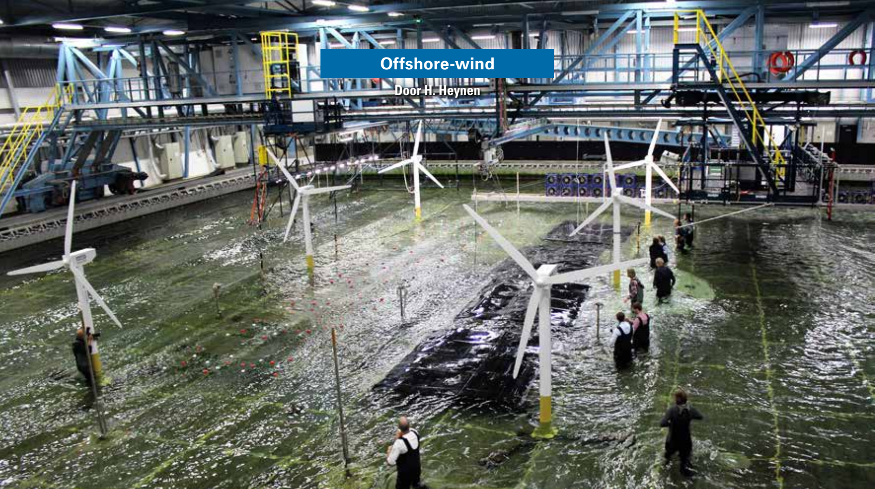
Proefopstelling van een sectie van een multi-use windpark in het offshore-bassin van het Marin. De golven op de foto zouden op zee tien meter hoog zijn (foto Hans Heynen).
