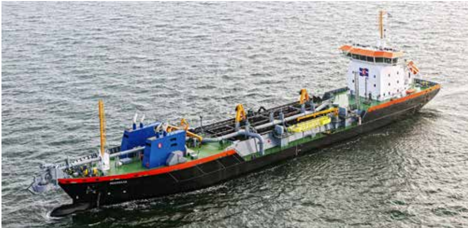
De Ecodelta is de eerste onder Nederlandse vlag varende door LNG aangedreven sleeppopperzuiger (foto Flying Focus).
