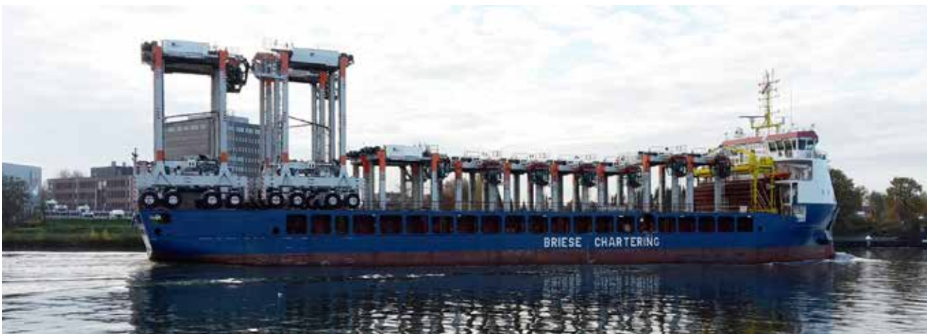
De Monika grotendeels open-top geladen met twaalf straddle carriers. De volledig geassembleerde straddle carriers (11,05 x 5,18 x 16,46 meter en 74,4 ton per stuk) waren in Gdynia en bestemd voor de GMP-containerterminal in Le Havre.
