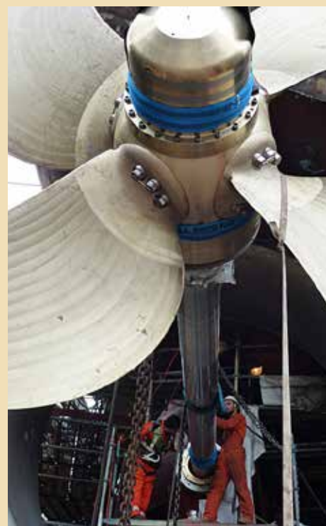
Watergesmeerde controllable pitch propeller- (CPP-) schachtinstallatie aan boord van de Polarcus Naila.
