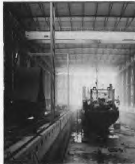
De hektrawler 'Cornelis Vrolijk' in de hal van de Frisian Shipyard, met links de nieuwe neussectie van het beschadigde schip. (Foto Flying Focus)
