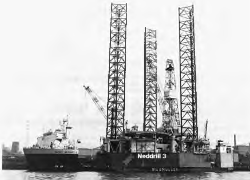
Het booreiland Neddrill 3 aan boord van de Super Servant 3
