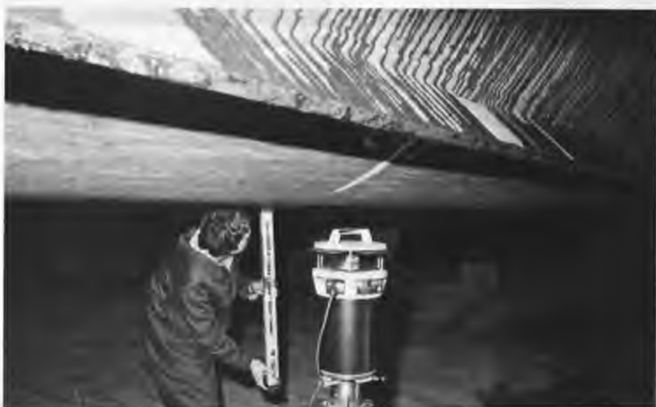
figuur 23: het nameten van een sectie m.b.v. een roterende laser met elektronische baak.
