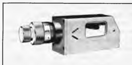
figuur 19: hellingmeter; onder helling instelbaar buisniveau, waarmee een nauwkeurige hellinginstelling van de kijker mogelijk wordt
