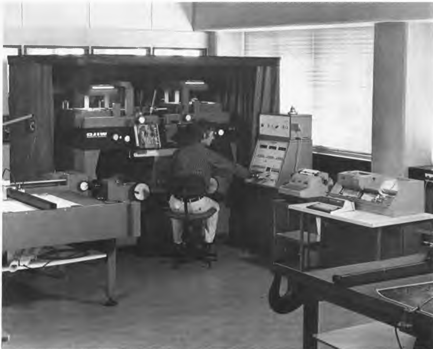
Figuur 7. Analoge uitwerkingsinstrument Wild A10.
