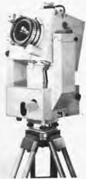
Figuur 2 is een voorbeeld van een single camera: de Jenoptik UMK 10/1318 FF meetkamera.
