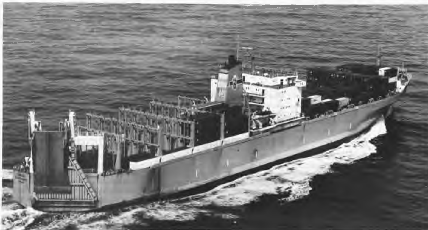
De 'Tadeusz Kosciuszko' (25.700 brt, bouwjaar 1981) is een goed voorbeeld van de veelzijdigheid in moderne ladingbehandeling, waarop Polen en Rusland de laatste tijd mikken. Duidelijk is te zien, dat zowel ro/ro-als containerlading kan worden meegenomen. Interessant is dat de cellen voor de containers ook bovendeks zijn opgetrokken. Het schip is eigendom van de Polish Ocean Lines
