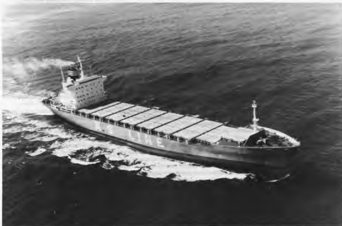
De 'Korean Wonis Seven' van de Korean Shipping Corporation, een 26.000 dwt containerschip, met de hoofdatmetingen: 208,10 x 30,50 x 18,20 x 10,85 m, voortgestuwd door een Sulzer 9 RND90M dieselmotor van 30.150 BHP bij 122 rpm. goed voor een snelheid van 21,9 knoop; het schip werd gebouwd op de Hyundai Ulsan Scheepswerf en geklasseerd door het American Bureau of Shipping.
