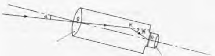
figuur 1: principe van een automatisch waterpasinstrument
