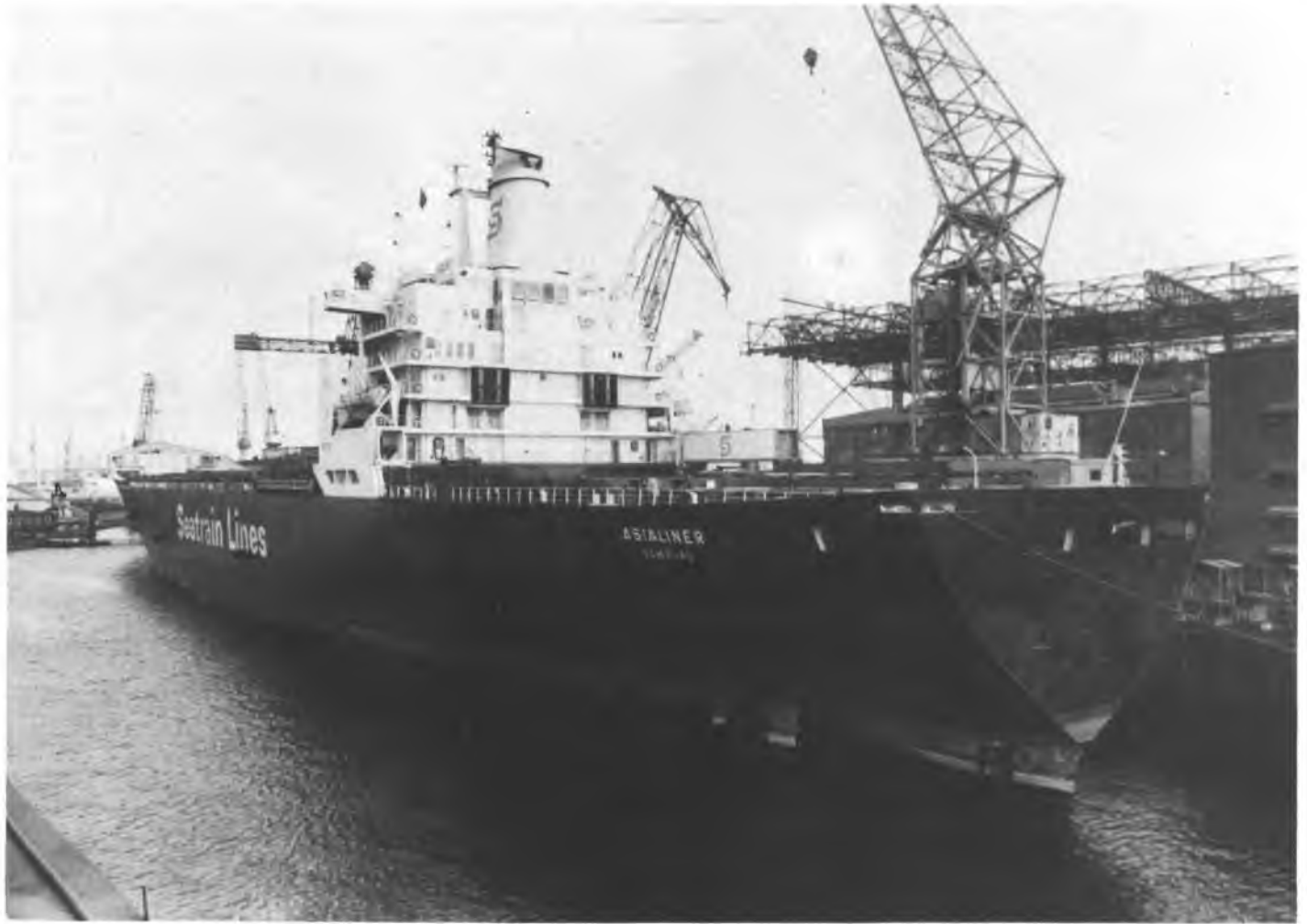
Fig. 1. Het eerste gasturbineschip van de Seatrain Lines dat werd omgebouwd op dieselmotoren
