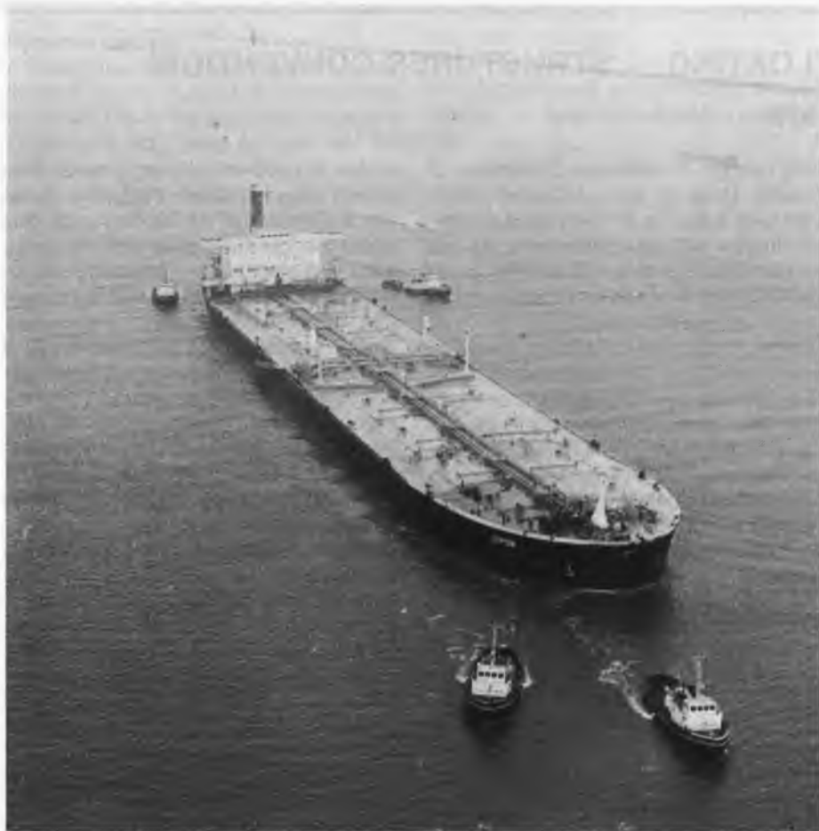
Figuur 5: Splinternieuw was de VLCC 'Lepton', toen het schip met instemming van de werf Verolme en de toekomstige eigenaar Shell aan enkele praktijkproeven werd onderworpen in het kader van de studie: Varen boven slib. Hier passeert de 'Lepton', geballast met water, de toegang tot de Rotterdamse haven. Waarnemers aan boord volgen het vaargedrag van het schip zorgvuldig. De 'Lepton' meet 318.000 ton dwt, is 350 meter lang en 55 meter breed. de diepgang was 20,90 meter, de gemiddelde keelclearance 1,60 meter, de gemiddelde sliblaagdikte 1,15 meter.
