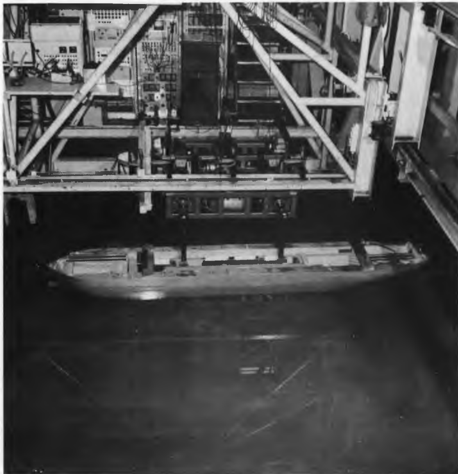
Fig. 1: Meetopstelling in het Nederlands Scheepsbouwkundig Proefstation in Wageningen, waar men – bij zorgvuldig nagebootste bodemcondities – een scheepsmodel aan allerlei experimenten onderwierp. Men nam draaicirkelproeven, spiraalproeven en zigzagproeven.
