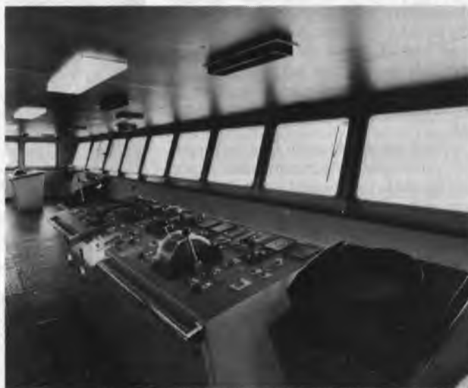
fig. 6. Brug met manoeuvreer- en bedieningslessenaar en navigatie-uitrusting
