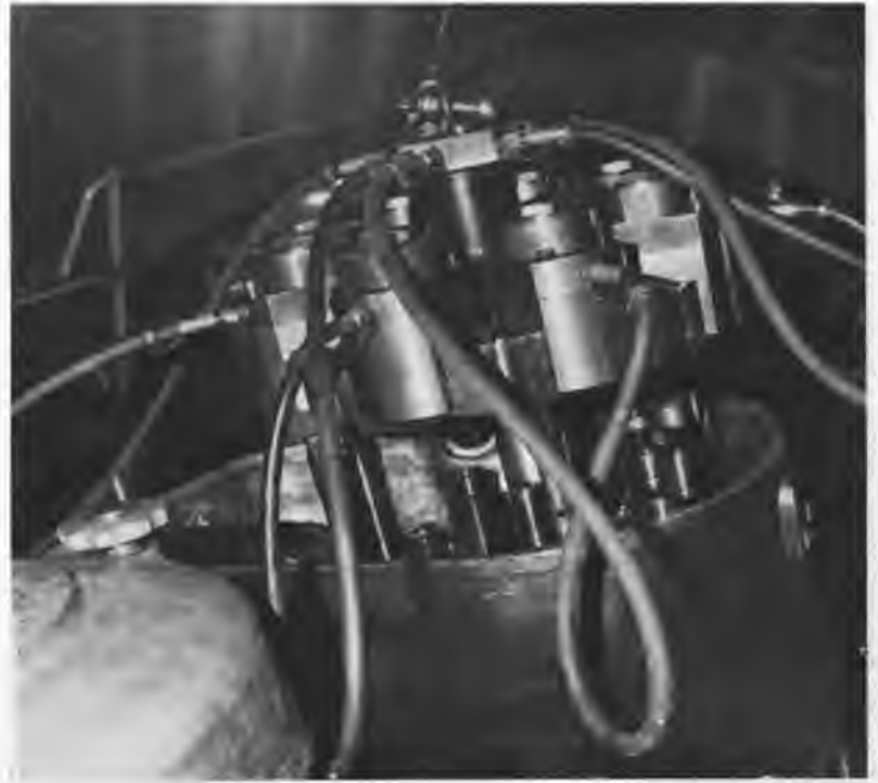
Fig. 5. Deze twee afbeeldingen laten de hydraulische apparatuur zien voor lossen en spannen der cilinderkoptapeinden van een PC3 motor.
