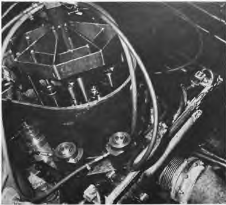
Fig. 5. Deze twee afbeeldingen laten de hydraulische apparatuur zien voor lossen en spannen der cilinderkoptapeinden van een PC3 motor.
