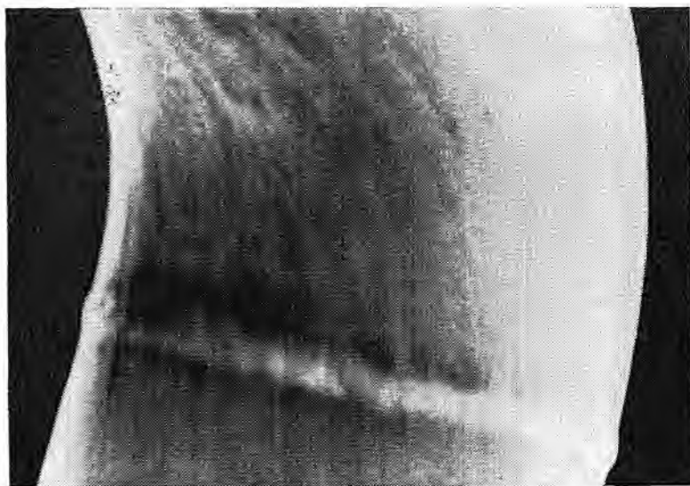
Fig. 17. Gammabeeld van pijpbocht die ernstige erosie laat zien
