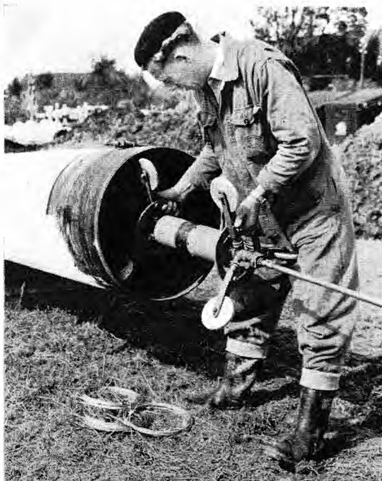
Fig. 10. Het gebruik van een rondstraalprojector (inwendige camera) voor belichting van montagelassen in een pijpleiding
