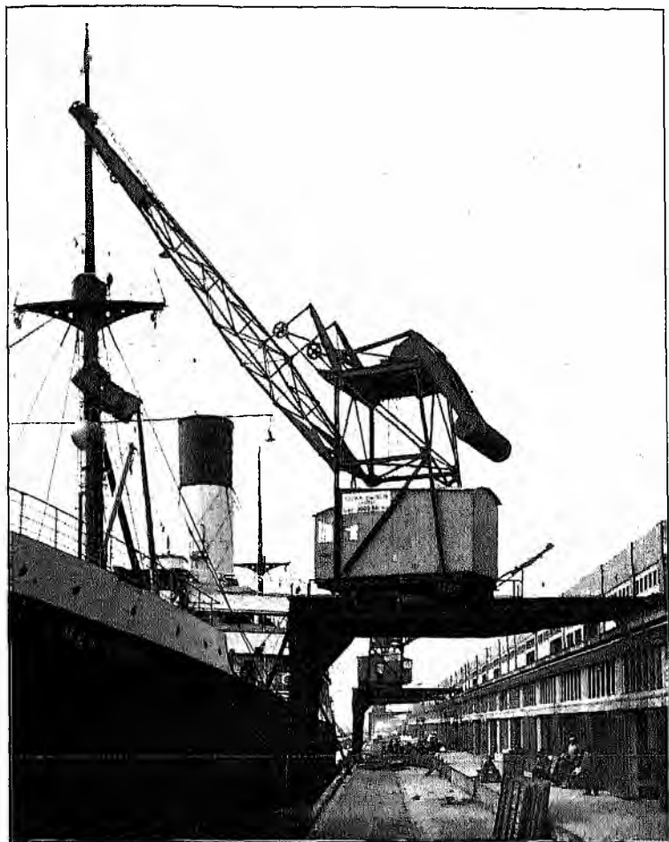
Portaalkranen door de N.L. Gebr. Stork & Co.'s Fabriek van Hirschwerkhuizen, te Hengelo, geleverd voor de haven van Kotka.
