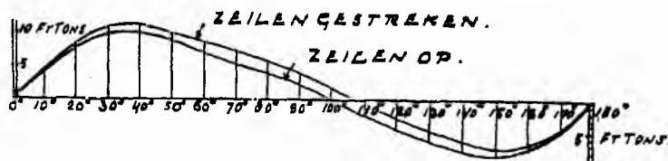
Afb. 6. Stabiliteitsmomenten van een niet zelfrichtende reddingboot (ontwerp Watson). Lengte 11,60 m, breedte 2,85 m. Depl. 7,5 ton. IJzeren kiel 2 ton.
