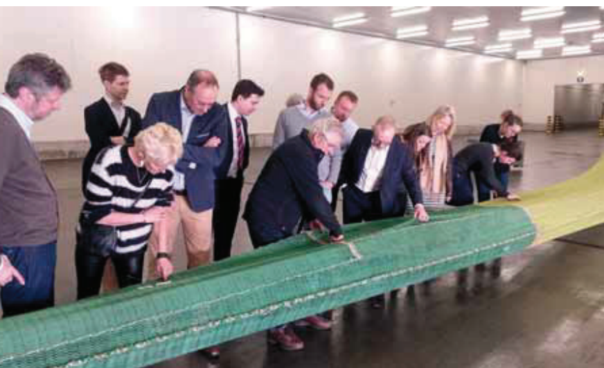
Het innovatieve netontwerp sepnep zorgt dat Noorse kreeftjes ( langoustines ) in de kuil belanden en ondermaatse vis ontsnapt.
