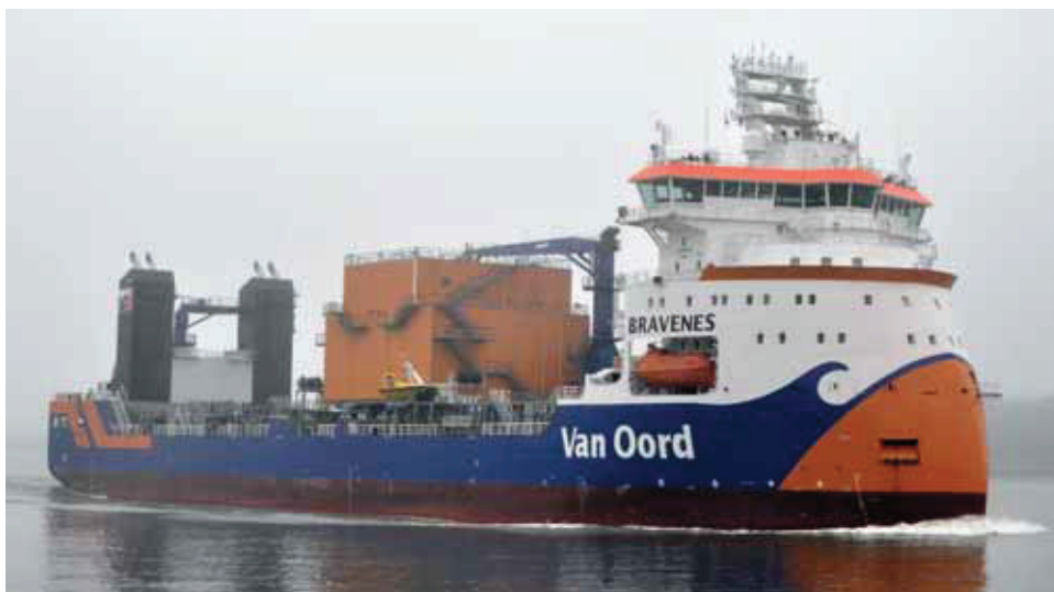
De ijsklasse-1A-DP3-steenstortor Bravenes met de opvallende X-bow (foto R. Zegwaard).
